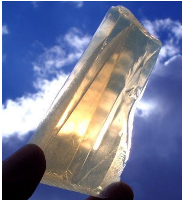
Figura 4. Materiale isolante che per il suo aspetto viene denominato “Frozen Smoke” (Fumo Congelato). L'aerogel è composto per il 90 – 92% da aria e 8 – 10% da silice.
