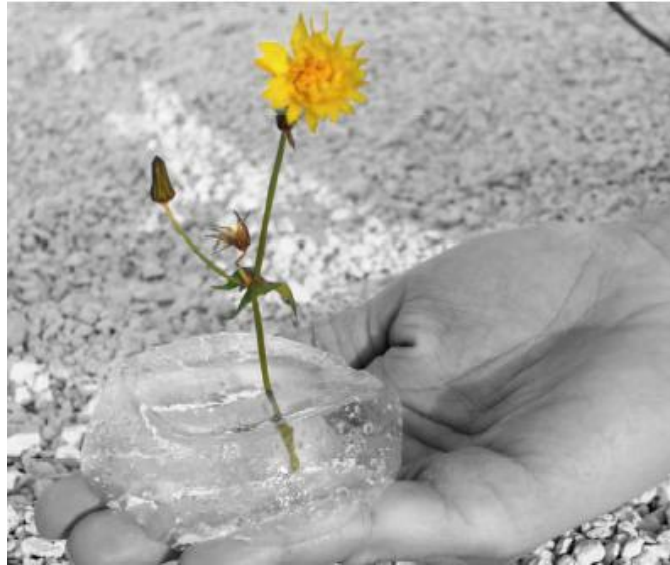
Figura 3. Gli idrogeli superassorbenti sono polimeri chimicamente reticolati aventi la capacità di assorbire fino a due litri di acqua per grammo di materiale secco.
